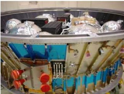
Figure A1.5-1 Propulsion Module
