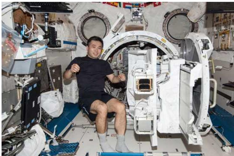
図 A4-1 きぼうのエアロックに J-SSOD を設置する様子
