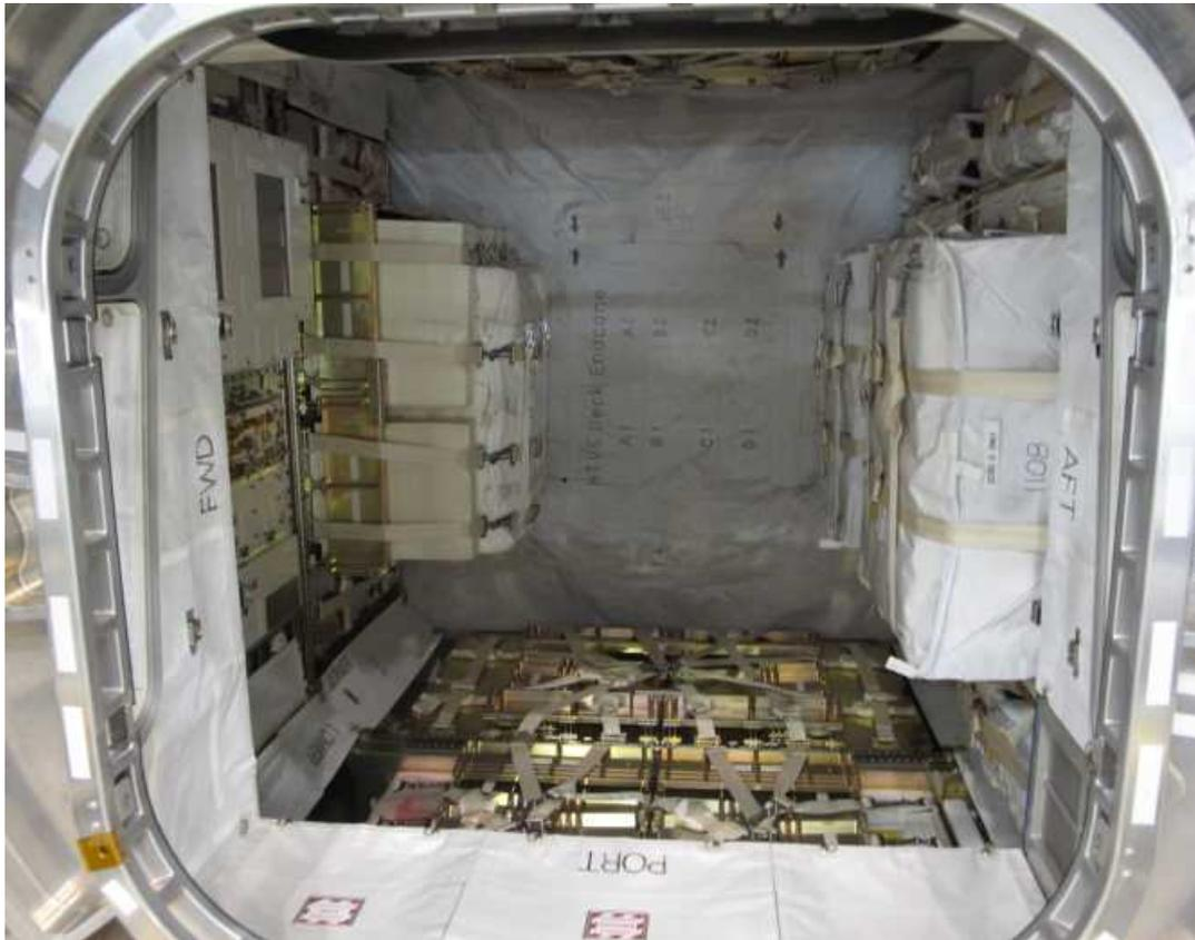
図A1.1-3 「こうのとりの」5号機内部のラック配置 (JAXA)
