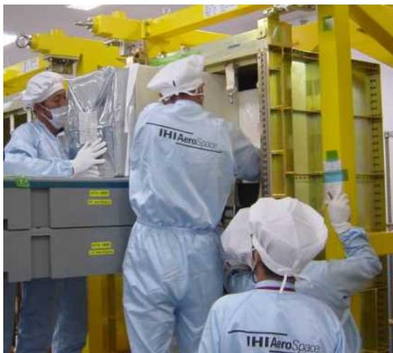
図5.1.1-4 HTV補給ラック(HRR)に搭載される物資輸送用バッグ(CTB)(JAXA)
