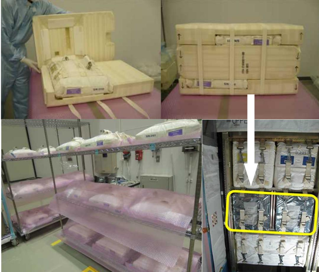
図A3-2 飲料水を充填した水バッグ(CWC-I)と梱包材(上:2号機、下:5号機)(JAXA)
