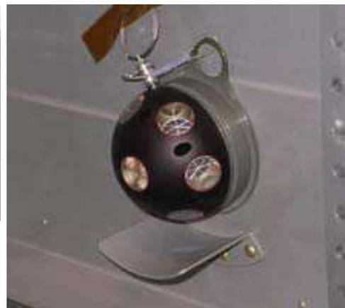
反射器(レーザーダリフレクタ)は、「きぼう」の下部に設置されたレーザ反射鏡です。HTVがISSの下方(地球方向)から接近する際に「こうのとりの」のランデブセンサ(Rendezvous Sensor: RVS)から照射されたレーザ光を反射します。
