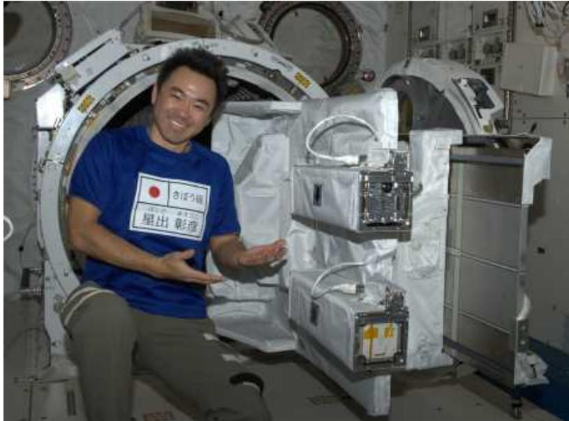
図A3-14 小型衛星放出機構 (3号機で輸送) (JAXA/NASA)
