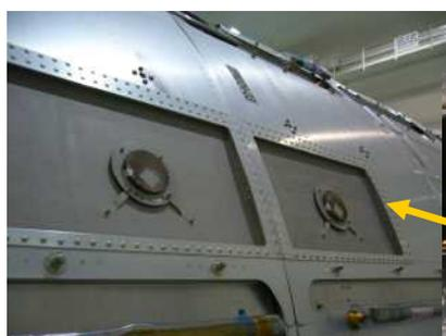
PROX通信アンテナは、ISS近傍に接近した「こうのとり」との直接無線通信に使われます。
