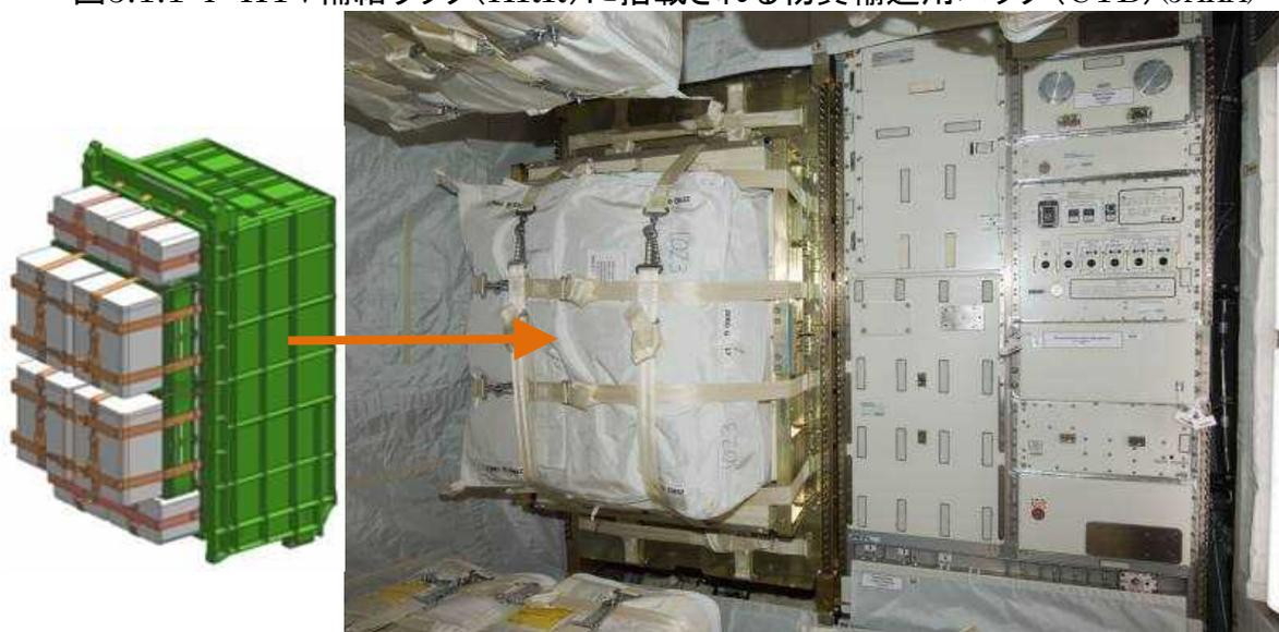
図5.1.1-5 ラック前面へ搭載された物資輸送用バッグ(CTB)の例 (2号機) (JAXA)
