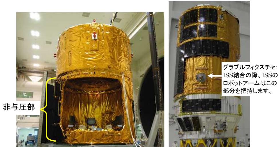
図A1.2-1 補給キャリア非与圧部(1号機)(左は曝露パレット搭載前)(JAXA)
