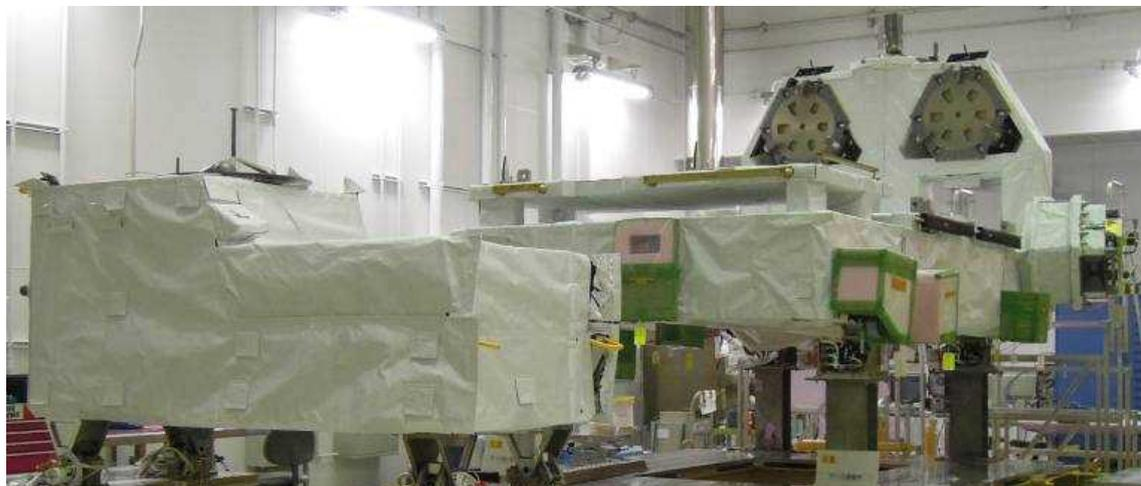
図5.1.2-1 5号機に搭載する曝露パレットと搭載前のCALET(左手前)(JAXA)
