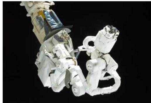
図A3-12 きぼうのロボットアームの子アーム(SFA) (1号機で輸送)(NASA)
