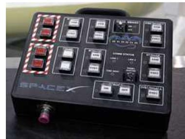
図A1.6-4 Space X社のドラゴン用の搭乗員用コマンドパネル(CCP) (Space X社)
