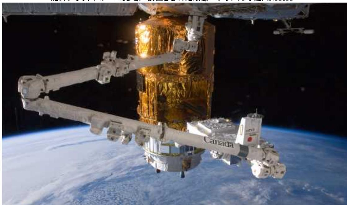
補給キャリア非与圧部に収納される曝露パレット(3号機)(NASA)
