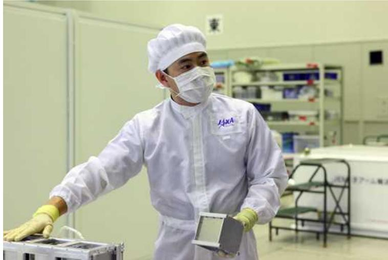
図 A4-4 CubeSat(星出宇宙飛行士が手に持っているのが 1U サイズの CubeSat)(提供 JAXA)
