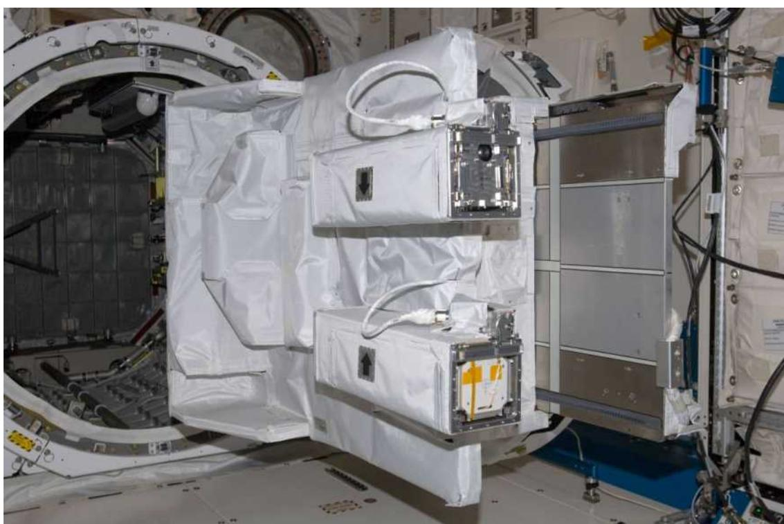
図5.1.1.3-7 小型衛星放出機構(J-SSOD)
